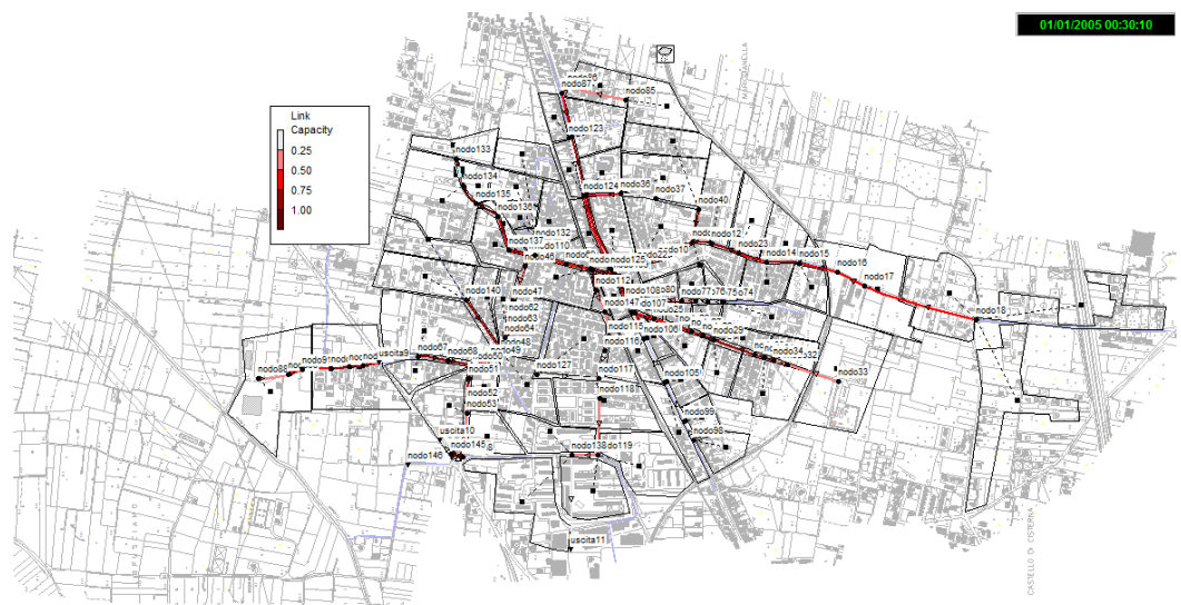
Figura IV: planimetria della rete fognaria con l'indicazione del grado di riempimento delle condotte al 30° minuto di simulazione.
